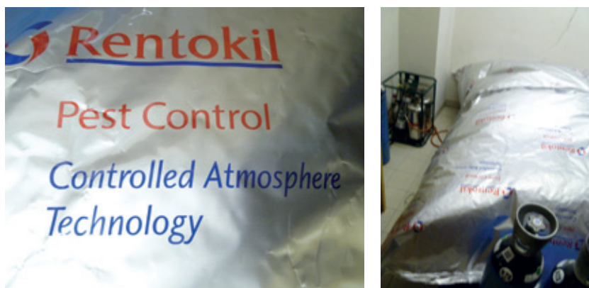
Controlled Atmosphere Technology. In een bubble vol boeken wordt zuurstof vervangen door een inert gas. Na ongeveer een maand is alle organisch leven afgestorven. © Openbare Bibliotheek Brugge
