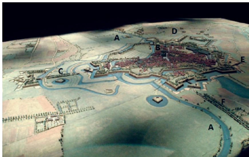
Achttiende-eeuws plan-reliëf van Menen bewaard in het Museum voor Schone Kunsten te Rijsel. Om belegeringen voor te bereiden bouwden de ingenieurs van het Franse leger nauwkeurige maquettes van verscheidene vestingen. Deze plan-reliëfs geven behalve een goed beeld van de vestingwerken ook een heel precies beeld van hoe de stad en de omstreken eruitzagen. Op de foto is te zien: A. Leie, B. stadhuis, C. Steenweg naar Rijsel (waar het douanekantoor was gevestigd), D. Steenweg naar Ieper, E. Steenweg naar Brugge, F. Steenweg naar Kortrijk. Met dank aan Dominic Goode ( www.fortified-places.com ).
