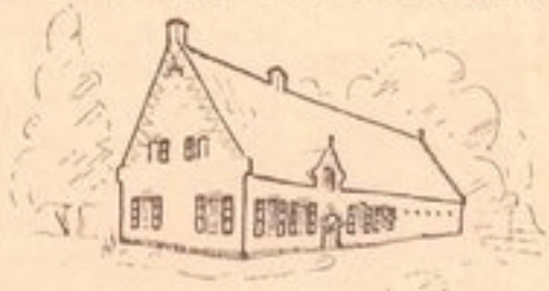
Zadeldak, topgevels met tandwerk.
