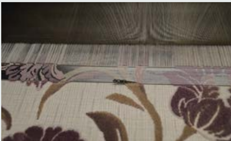
Roedenweefsel op een hedendaagse roedenweefmachine (oktober 2017). De snijroede snijdt de lussen open zodat rechtopstaande pooltjes ontstaan. (Foto genomen bij Weverij Van Neder, Vichte door A. Blancke).
