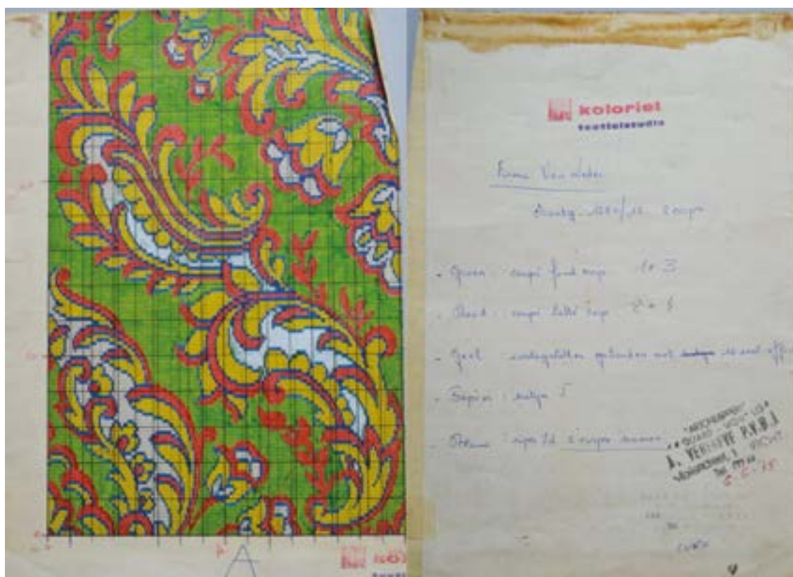
Voor- en achterzijde kaarttekening uit 1975, Weverij Van Neder Vichte. Op de achterzijde: vermelding ontwerp bureau Koloriet, kleurenlegende en stempel kartonkapperij Vererve (foto: A. Blancke).
